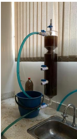
Reactor UASB escala laboratorio.
